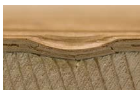
Herkömmliches Parkett mit Fichte-Mittellage (Deckschicht Eiche 3,6 mm)
