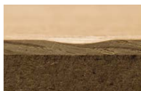
moderna parkett mit HDF-Mittellage (Deckschicht Eiche 2,5 mm)
